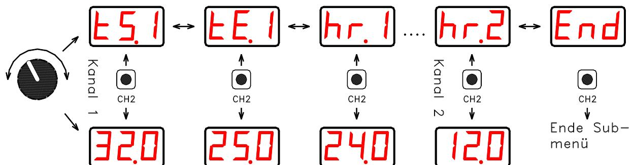
Zu beachten ist, dass der programmierte Startwert immer größer sein muss als der Endwert. Sollten die Werte nicht korrekt programmiert sein (**tS.. <= tE..**), kann der Timer nicht gestartet werden. Die Regelung erfolgt dann weiterhin nach dem Wert **tE..**. Tritt bei der Eingabe eine längere Pause auf (ca. 3 Minuten), wird die Programmierung abgebrochen. Nicht bestätigte Werte werden verworfen.
